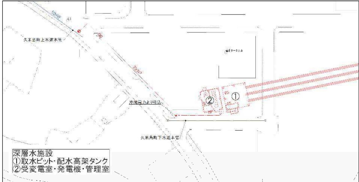
図 11.4-1 深層水配置計画図(Q=30,000m 3 /日)
