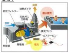
天然ガスを燃料として発電機で電力を作ると同時に、排熱は「熱交換器」で温水にしたり、あるいは「排熱回収ボイラー」で蒸気と温水にする。電気と熱の利用効率は80%にもなる。
