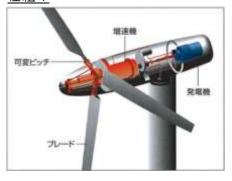
風の運動エネルギーを風車により回転という動力エネルギーに変え、その回転を歯車等で増速して発電機を動かし、電気エネルギーへの変換を行う。
