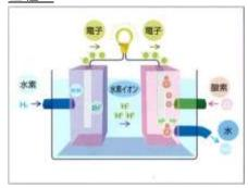
原理は 1839 年にイギリスのグローブ卿によって発明され、宇宙船の電源として開発されてきた燃料電池。水の電気分解と逆で、正極側に酸素(空気)を負極側に水素を供給し水ができる過程で発生する電気を利用する。
