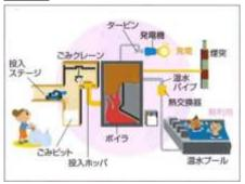
ごみを焼却する際の熱で発生する高温燃焼ガスによりボイラーで蒸気を作り、その蒸気でタービンを回転させて発電するもの。また、その際に発生する熱を温水等の形で取り出して有効に活用することができる。
