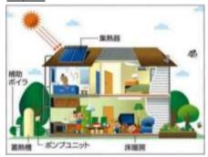
システム規模によって若干の違いはあるが、太陽熱を効率よく集める「集熱器」、集めた熱を蓄える「蓄熱槽」、少ない熱損失で熱を輸送する「熱輸送系」、熱を効率良く利用する「熱交換器」と「断熱材」等によって構成される。
