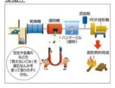
RDFは、集められた「燃えるごみ」を乾燥させた後、選別機で混入している「燃えないごみ」を取り除き、これをハンマーミルで粉砕。更に、腐食を防ぐ添加物を加え、RDF成型機にて圧縮して固形の燃料を製造する。
