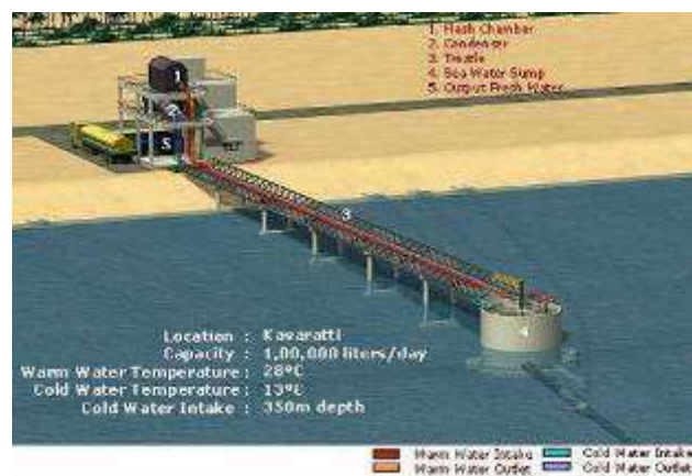
図 4-13 NIOT 100m 3 /日 海水淡水化プラントの概要図
