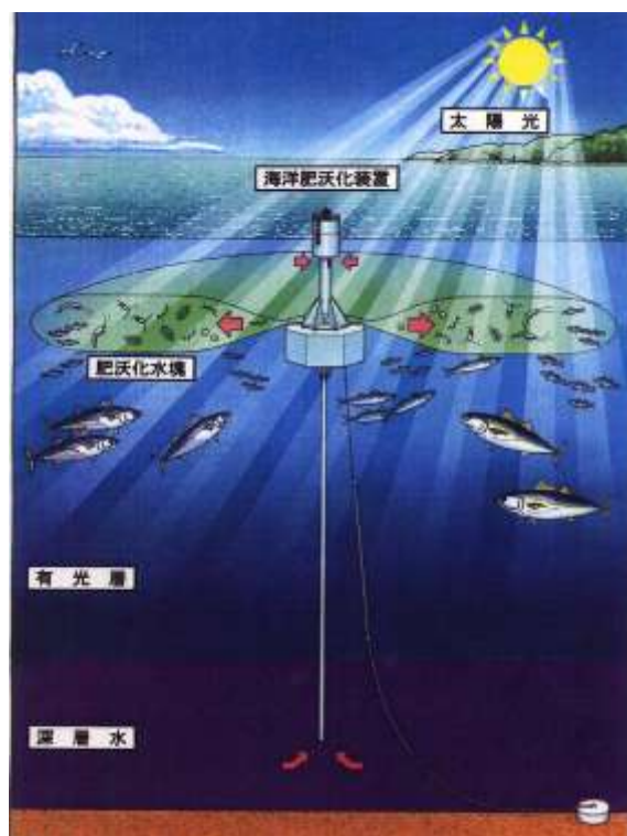
図 7-1 浮体式の海洋肥沃化装置「拓海」コンセプト図
